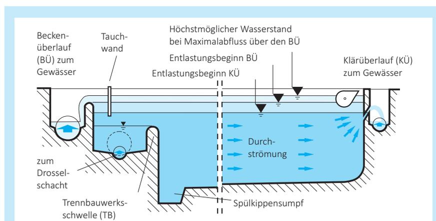
**Bild 1:** Längsschnitt eines typischen Durchlaufbeckens in Nebenschlussanordnung
